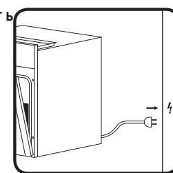
Подсоединить кабель согласно табличке со схемой подключения к соединительному зажиму
